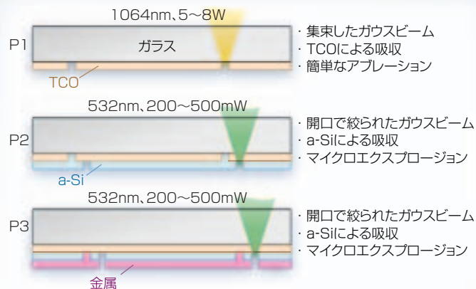
図3 P1では集束したNIRレーザー光を用いてTCOを除去する。P2とP3ではTCO-Si界面の緑色レーザー光の選択吸収性とマイクロエクスプロージョンリフトオフを利用してSiを除去する。
