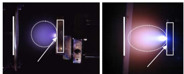
写真5 スポットサイズに依存するブルーム形状 絞られた焦点では球状(右写真)となる
