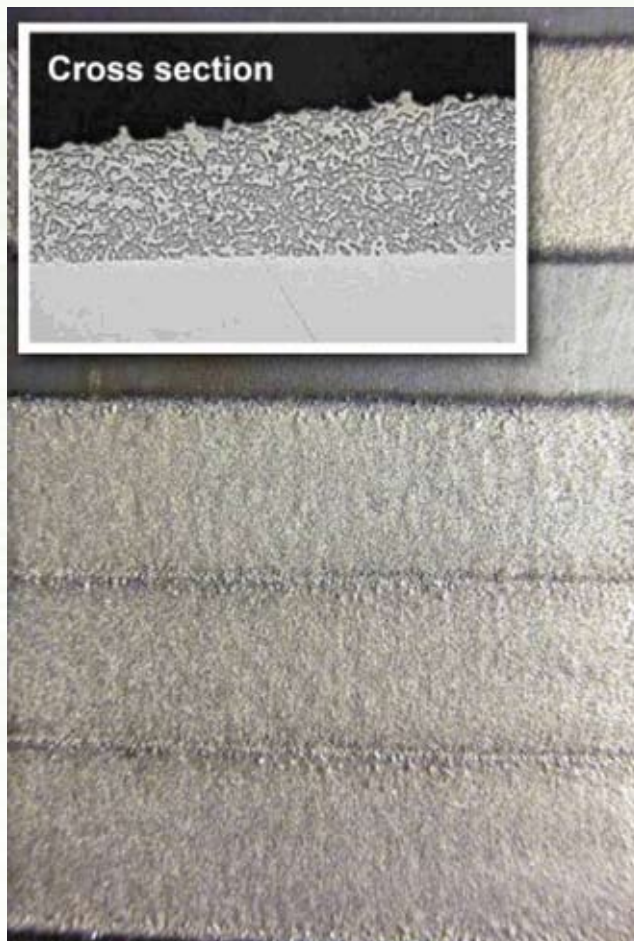
図2 大面積における厚み0.4mmの金属結合クラディング写真。同程度のサーマル・スプレー法クラッドと比較し、G65耐摩耗テストにおいて2倍の耐摩耗性能を持つ。1018鋼板上にヘガネス社製1559-40-60% (NiWCパウダーと60% WC)をクラディング。3 X 24mmビームを使用し、オーバーラップ3mmで20mm幅の有効クラッドを作成。7kWシステム、プロセス速度:1.08m/分にて加工。
