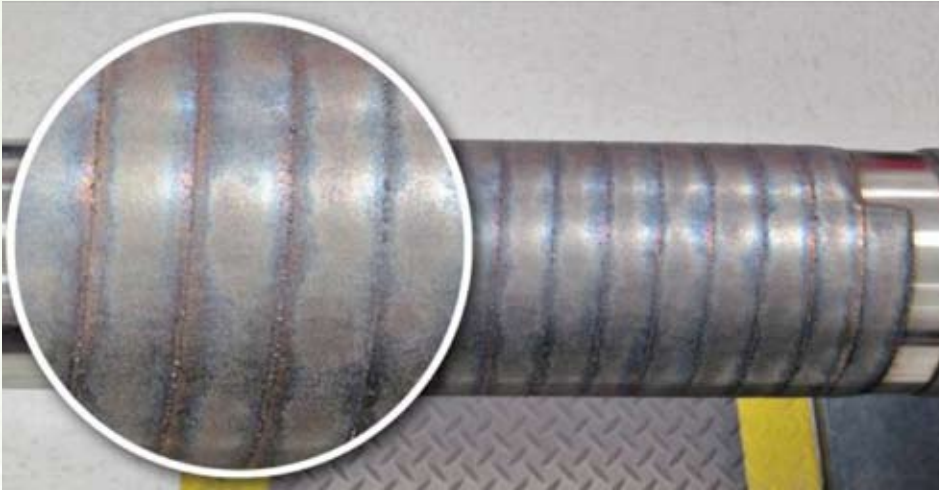
図3 SU316Lステンレス・スチール・シャフト上の大面積クラディング。(30% WCを含んだNiWCパウダー(客先支給)使用)8kWレーザー出力、有効幅20mmにて、100mm径 X 330mm長 X 1.5mm厚にてクラディング。加工速度は、0.4m/分。
