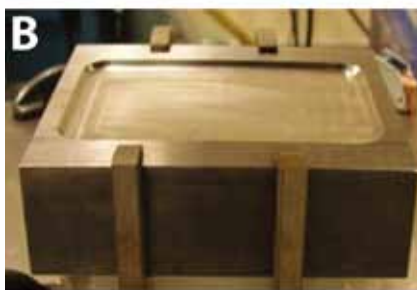
図3 軸受鋼のブランクの従来のブランク(A)と自動クラディング用に改良したブランク(B)の設計を示している。
