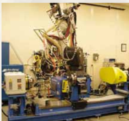
図2 アリオン社のALCはクラディングと表面硬化の用途を支援する。
