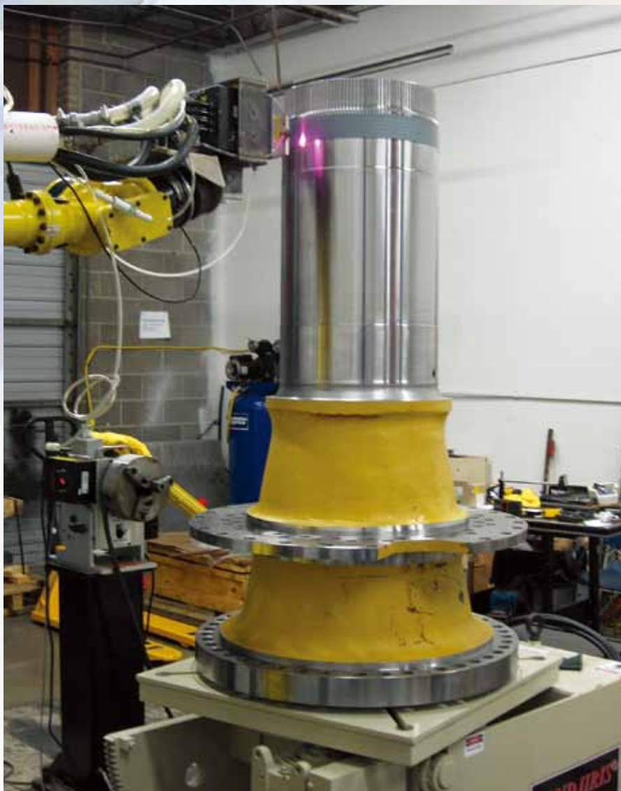
図3 ダイレクト半導体レーザーは小型で使いやすく、大面積の部品や接近の難しい場所を加工できる。ここでは大型車両のホイールスピンドル表面にあるベアリング接触部分の熱処理をしている。
