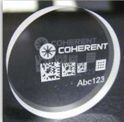
図3: サファイアをピコ秒のパルス幅のレーザーでマーキングした例: サファイアは極端に硬いため、他の方法では困難でした。
