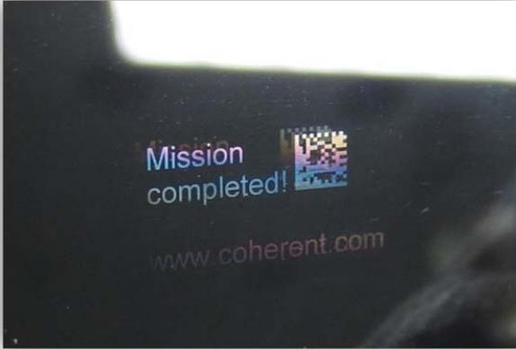
図2: Helios(波長 532 nm)によるガラス上のカラーマーキング
