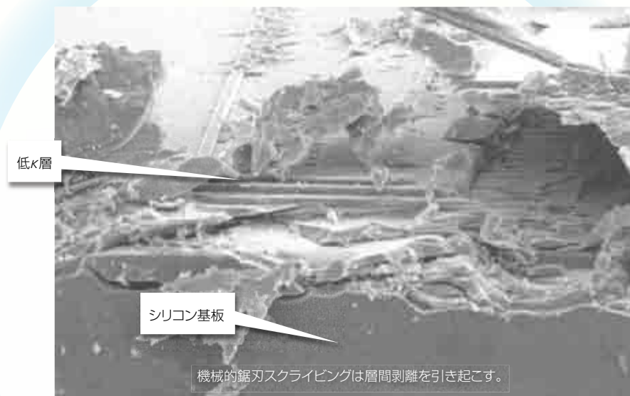
図5 低 \kappa 材料を用いる半導体チップはレーザースクライビングを使用してチップ間のストリートを加工する。このレーザースクライビングは亀裂発生を防止し、回路に損傷を与えない高速切断を行うことができる。
