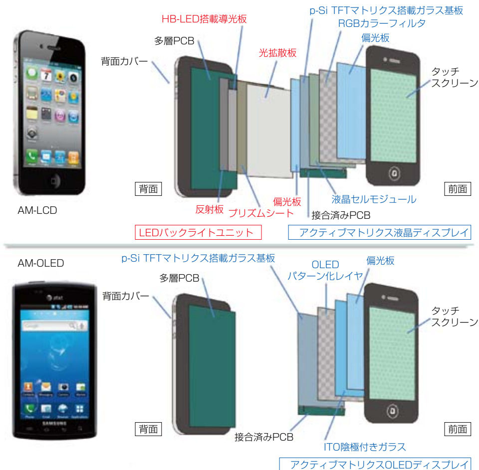
図1 液晶ディスプレイ(LCD)および有機発光ダイオード(OLED)ディスプレイを搭載するスマートフォンの構造。
