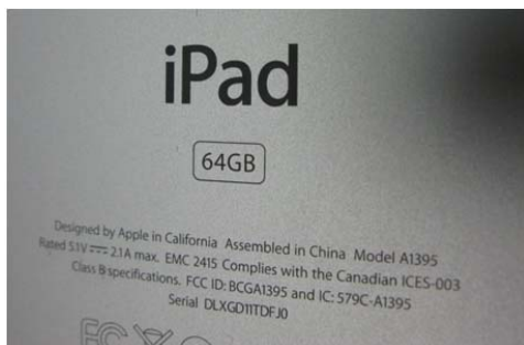
図3: アルマイト処理されたアルミ表面下にコントラストの強いマーキングを入れる「ブラックマーキング」
