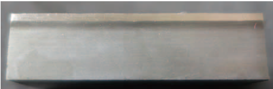
図4 低炭素鋼へのInconel 625クラッドの断面積。ホットワイヤークラディングがプラズマ粉体肉盛(PTA)を使用した場合に比べ、低い希釈(ここでは、8.5%)で均一なクラッドが得られていることを示している。クラディングは、8.5kWのレーザ出力、1270mm/分の速度、12.7m/分のワイヤー供給速度で行われた。
