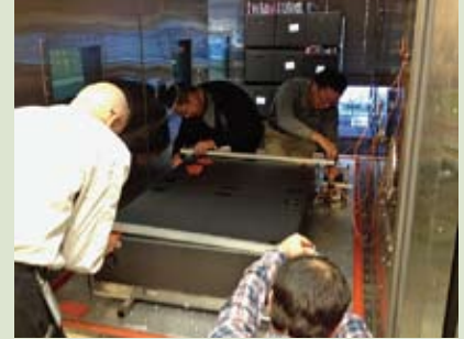
図A 産業グレードの信頼性提供の決め手になるのは、HASS 試験である。ここでは、レーザーを包括的な「シェイク&ベイク」テストにかける前に、コヒレント社の技術者が環境テストチャンパ内の除振台に固定している。
